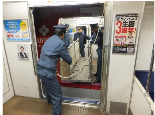
救出器具の設置
