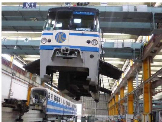
車体塗装や検査のため車体分離作業
