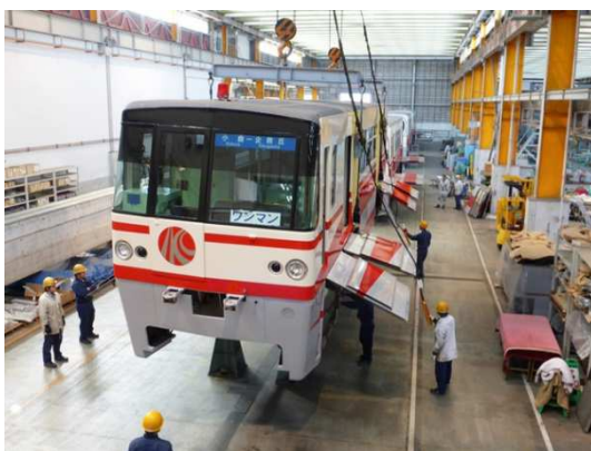
車体塗装や検査のため車体分離作業
